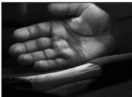
Hand, mit Feuchtigkeitscreme leicht eingecremt, nach einmaligem Anfassen eines gummiummantelten PAK-belasteten Hammerstiels. Unter UV-Licht ist Fluoreszenz an den Kontaktstellen erkennbar<sup>6</sup>.
